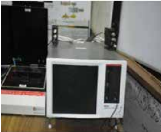
चित्र 29 (क): समर्पित NVM लक्षण वर्णन परीक्षण-बेंच और अनुकूलित FPGA आधारित परीक्षण मंच।
