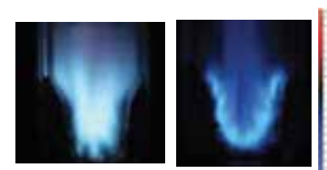
चित्र 47 : ऊर्ध्व वेग पर LDI-4C बर्नर में अग्नि लपट (बाएँ) 5m/s ( \Phi=0.6 ) और (दाएँ) 2 m/s
